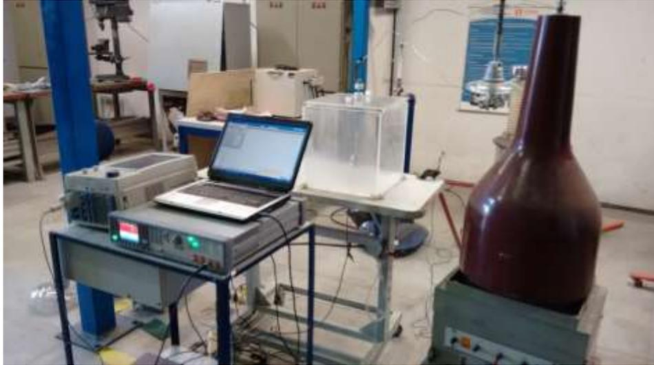
Figura 40 – Arranjo experimental para os ensaios de ruptura dielétrica
