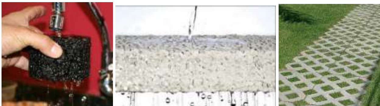
FIGURA 61 – ASFALTO POROSO (ESQUERDA), CONCRETO POROSO (MEIO) E BLOCO DE CONCRETO VAZADO (DIREITA)
