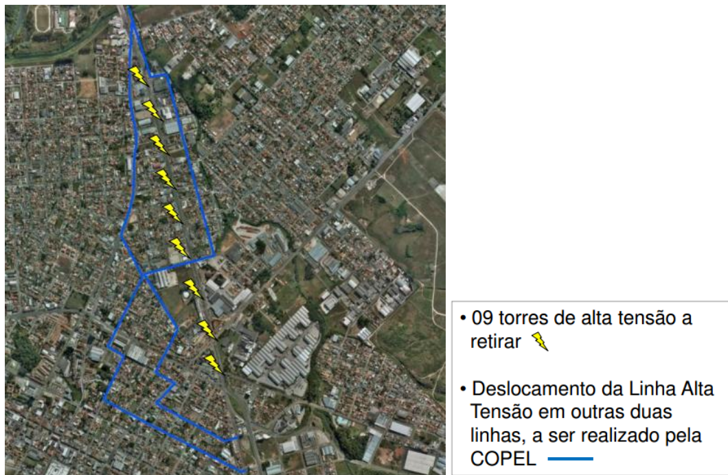
FIGURA 87 – RETIRADA E DESLOCAMENTO DAS TORRES DE ALTA TENSÃO. PAC DA MOBILIDADE/ COPA 2014. FONTE: COMEC
